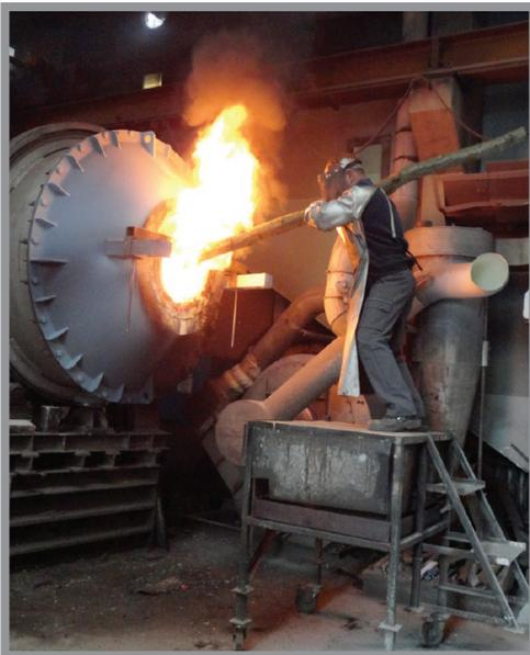
Am Hochofen wird stirnseits eine Verschlusskappe geöffnet und der riesige Deckenkran nimmt sie weg. Dann rühren Gießer, sich der enormen Hitze wegen abwechselnd, mit einem Erlenstamm die breiige 1200 Grad heiße Gussmasse kräftig durch, bis alles gut vermengt ist. Eine faustgroße Schmelzprobe wird entnommen, nach ihrer Aushärtung zerschlagen und der Meister prüft an den Bruchkanten, ob die erforderliche Materialfestigkeit gegeben ist.
